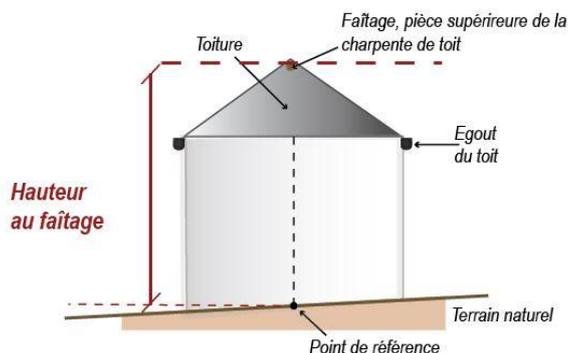
1 – Pour les toitures en pente : la hauteur au faîtage se mesure du sol naturel avant remblai au point le plus haut de construction (ligne de jonction supérieure de pans de toitures inclinées suivant des pentes opposées).
