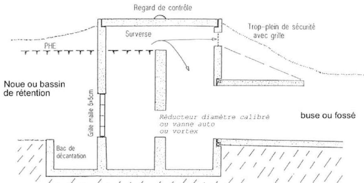
**PETIT OUVRAGE EN BÉTON AVEC ORIFICE ET SURVERSE INTERIEURE**
