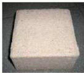
Pavés en béton poreux
