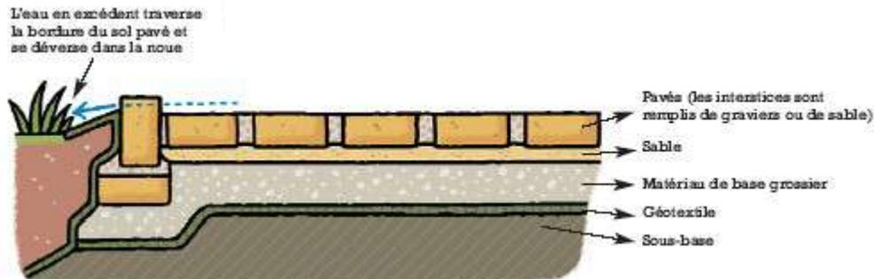
**STRUCTURE D'UNE CHAUSSEE POREUSE**
