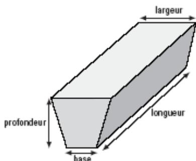
La porosité dépend du matériau de remplissage de la tranchée. Par exemple, pour un remplissage avec des galets la porosité est de l'ordre de 0,35. Cette porosité est largement augmentée en remplissant avec des matériaux spécifiques en plastique alvéolaire, elle peut atteindre 0,90.
