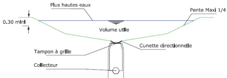
**Bassin à sec à alimentation par mise en charge du réseau et débordement sur le côté –
