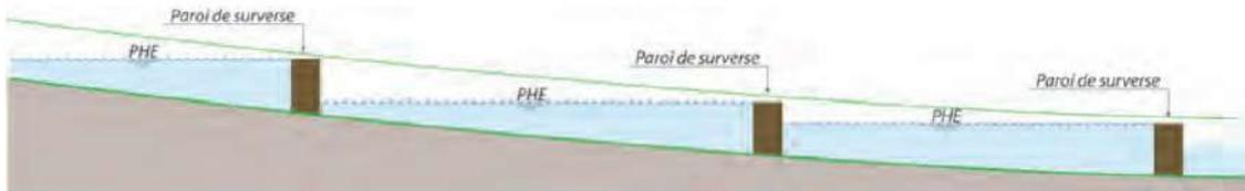
**PROFIL EN LONG TYPE D'UNE NOUE SUR TERRAIN FORTES PENTES**
