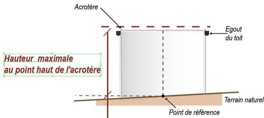
2 – Pour les toitures plates dites « toitures-terrasses » : la hauteur à l'acrotère se mesure du sol naturel avant remblai au point le plus haut de l'acrotère (relief constitué par un muret situé en bordure de la toiture, dans le prolongement de ses murs de façade).
